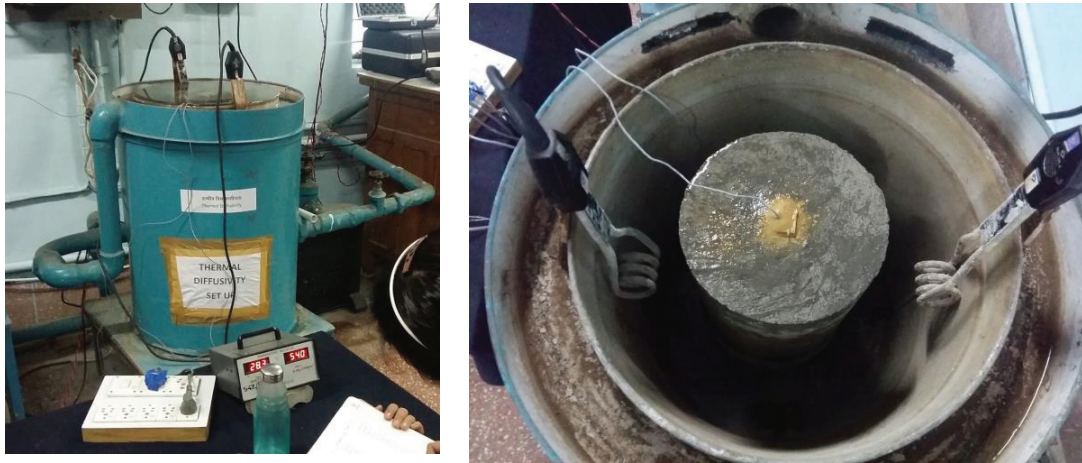
Fig. 6 : Diffusivity Test set up
